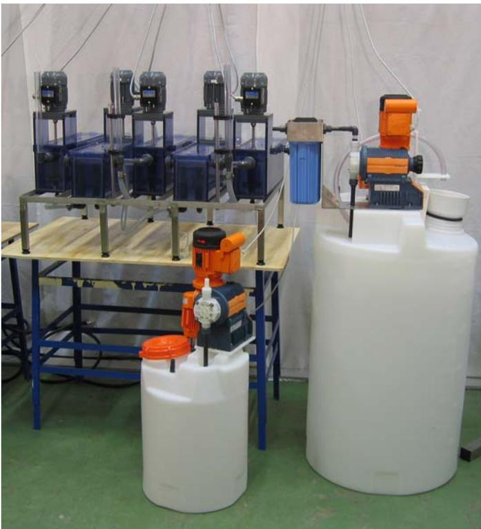
我公司可根据客户的需求采用不锈钢（SS）、聚丙烯（PP）、聚氯乙烯（PVC）、聚氟乙烯（PVDF）制造 MSU 实验型混合澄清装置。本装置通常用于试生产型实验，以对溶剂萃取流程的工艺条件进行评估和说明。I
