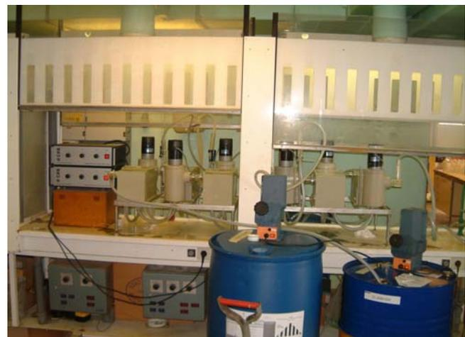
实验型和小规模混合澄清装置适用流量（有机+水相+回收）范围：**50—500 升/小时**。
