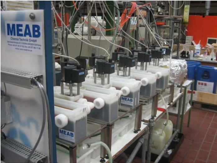
实验型和小规模混合澄清装置属于传统型设计的泵—混合澄清装置，具有方形混合腔（混合器）和箱式澄清室（澄清器）。混合器装有变速搅拌器，澄清器装有围栅，可用于在整个澄清器截面上分布分散相，供较重溶剂流出的可调溢流管可按照不同的液体密度控制相界面。较重溶剂循环也可整合至装置构造中。各装置均可借助水压独立运行，因此所有装置均能逐一水平安置，这种布置使得试安装非常灵活。经验表明，上至实验研究，混合澄清器可以生成可靠的化学数据，并提供充足的产物溶液用于进一步测评；下至生产实践，混合澄清器又可将化学品消耗、机器维护与操作看守以及其他相关费用降至最低限度。
